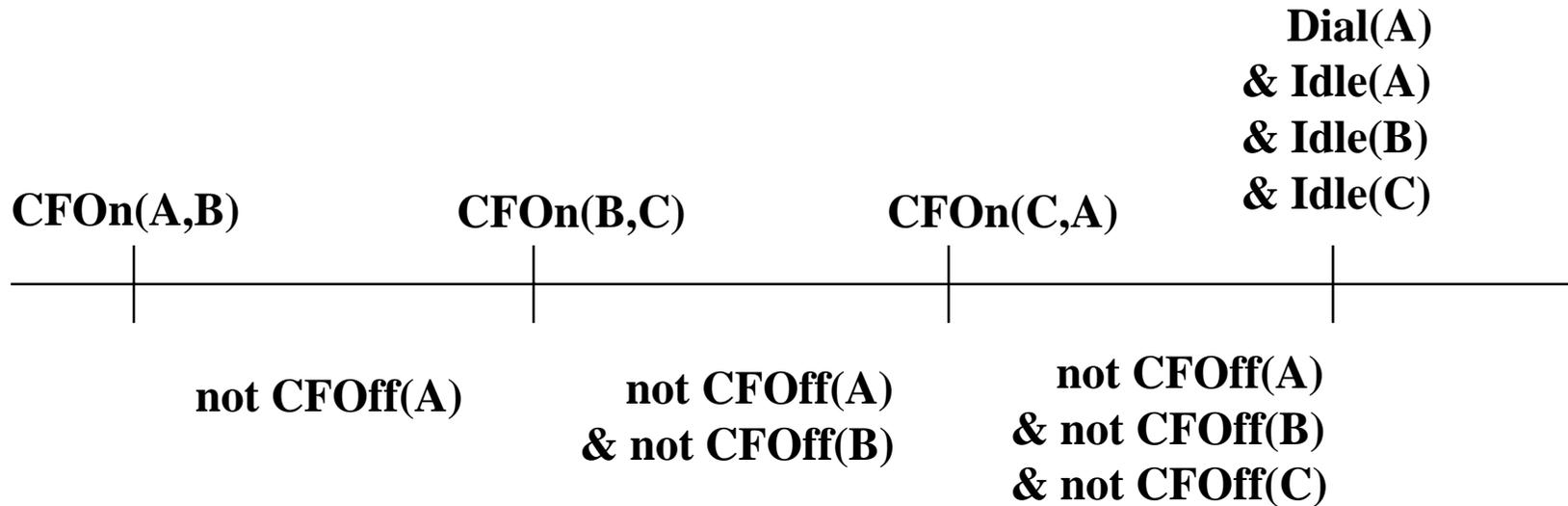
Ce schéma permet d'observer la réaction du système quand le nombre maximum de renvois est atteint
